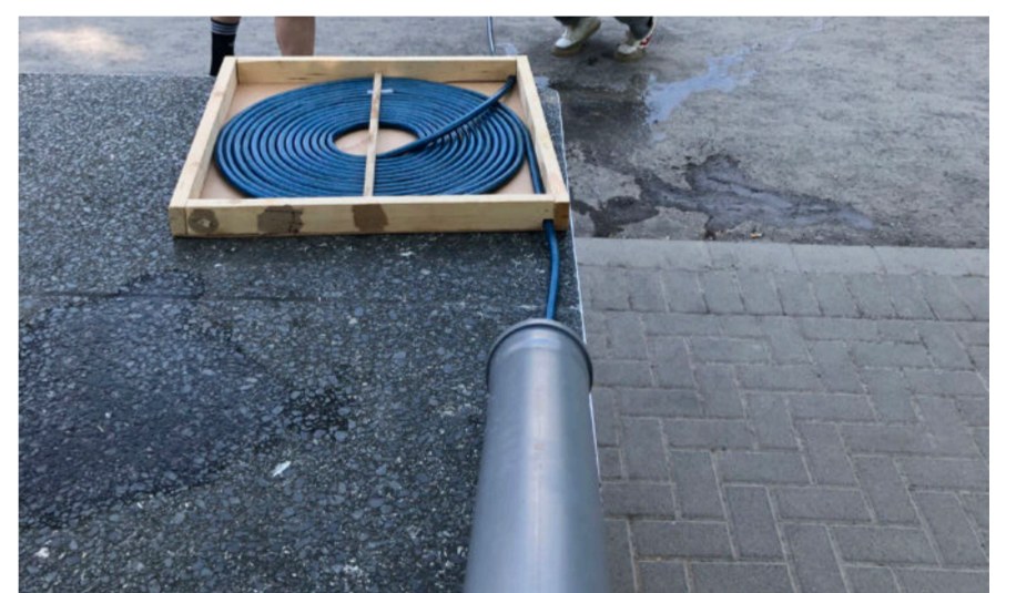
Ein geneigtes Abflussrohr dient als Wassertank (10 l) und wird mit dem Schlauchsystem verbunden.
